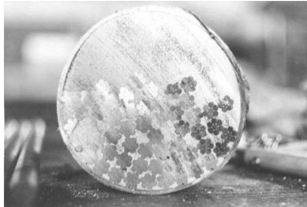
Fig. 27, PT tendon bundled end and section (Berg and Schokker)
